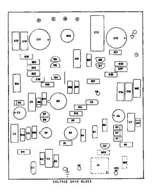
MODULE CIRCUIT BOARD PARTS LAYOUT
